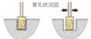
穿孔状況図 マルチレイヤーは溝がガイドになりブレにくい(2"以上) 一般的なコアビットブレやすい
